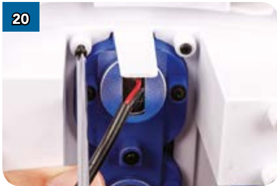
20 Закрепите панель двумя саморезами 2,3 x 6 мм наверху...
