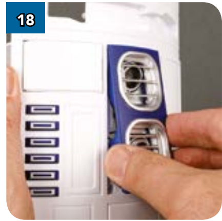
18 Вставьте накладку: её штифты должны войти в предназначенные для них углубления в панели...
