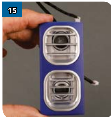
15 Накладка с установленными решётками и датчиком должна выглядеть так, как показано на фотографии.
