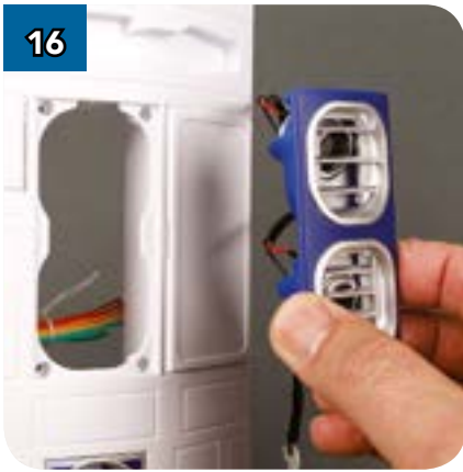
16 Поднесите накладку (BP-44) с датчиком к панели (BP-42) так, как показано на фотографии...
