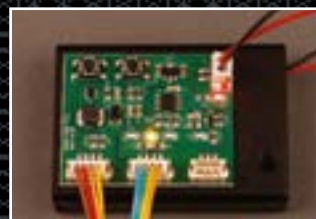
ШАГ 5. Поднесите к датчику плотный лист бумаги формата А4 (или любой другой предмет такого же размера). Как только предмет окажется на расстоянии полуметра от датчика, должен загореться жёлтый светодиод. Если всё работает исправно, отключите батарейный отсек и отсоедините провода.
